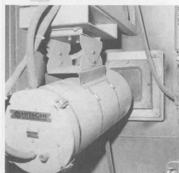
▲第1号炉の中は700℃以上の高熱。これは監視カメラです
