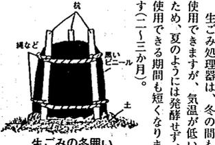
生ごみ処理器は、冬の間も使用できますが、気温が低い場合、夏のように発酵せず、使用できる期間も短くなります(二〜三ヵ月)。
