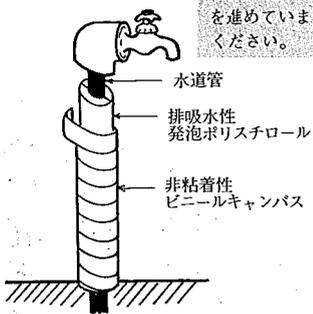
水道管を見回ってください。また、凍結による破裂事故を防止するために、窓のようになんらかの防寒装置を、必ずつけています。一セット四百七十円で、水道センター(水道局内)で販売しています。ご利用ください。
